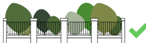
Oszlopos kerítés 1/3-ad lábazat és 2/3-ad áttört résszel.
